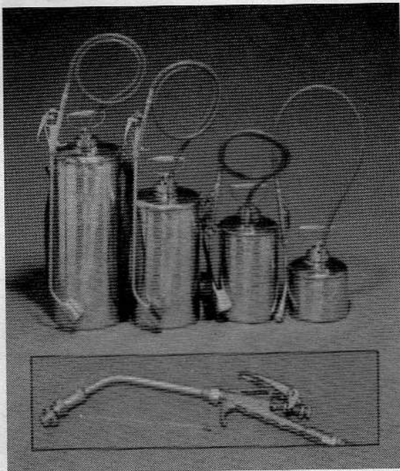
Figura 5-A Las aspersoras de aire comprimido están disponibles en varios modelos y capacidades de tanque, variando de capacidad desde medio galón a 3 galones. Los tanques más grandes vienen con unos tirantes para ponerse al hombro. Algunas boquillas vienen con accesorios de extensión o "popotes" para aplicación en grietas y hendiduras como se muestra en la figura.
